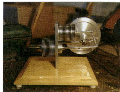
Del poklicne mature je tudi izdelek s seminarsko nalogo. Nejc Koželj je izdelal Stirlingov motor, mehansko napravo, ki pretvarja toplotno energijo v mehansko delo.
